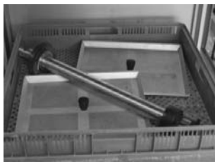
Positie van de schone onderdelen na het afwassen.
